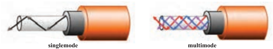
شکل ۱۱-۴- فیبر تک حالت و چند حالت
