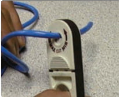
شکل ۴۴-۴- روکش‌برداری از کابل شبکه
