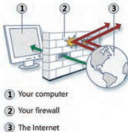
شکل ۷-۱- تصویر عملکرد دیوار آتش
