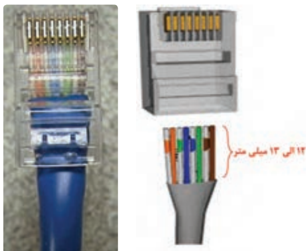
شکل ۴۶- سوکت زدن به سر کابل
