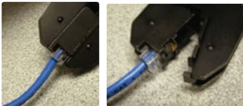
شکل ۴۷- پرس سوکت های کابل شبکه
