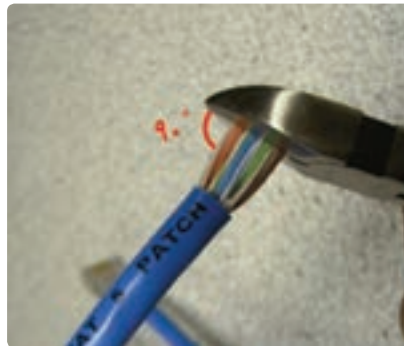
شکل ۴۵-۴- برش سیم‌های کابل شبکه
